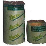
Leca Pipeforing, Standard (chamotte). H = 500 mm og 250 mm. Innvendig/utvendig diameter 200/250. Densitet 2.100 kg/m 3 .
