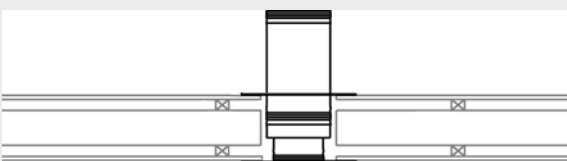
Avslutning av helisolert pipe i etasjeskille. En dekkplate monteres i himlingen for å skjule pipa.
